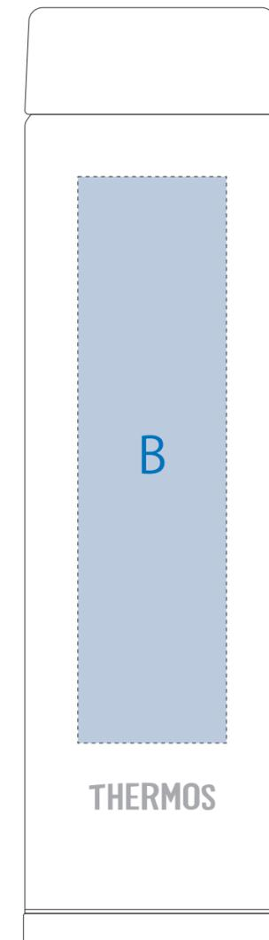
■UVインクジェット印刷 最大範囲：B / W26×H100(mm)
