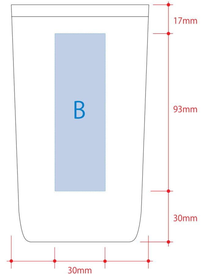
インクジェット印刷 最大範囲 : B / W30×H93 (mm)
