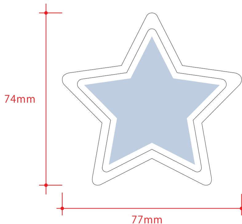
インクジェット印刷 最大範囲：W58.213×H55.148(mm)
